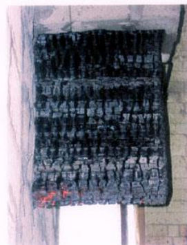
Snimak 5 – Izgled izložene strane uzorka neposredno po završetku ispitivanja
